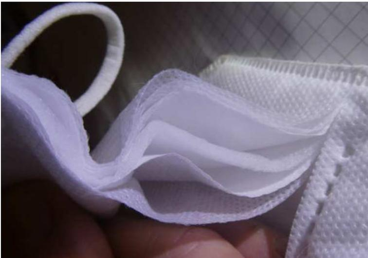
Bild 2: Maske – Schnittdarstellung – 6 Schichten
